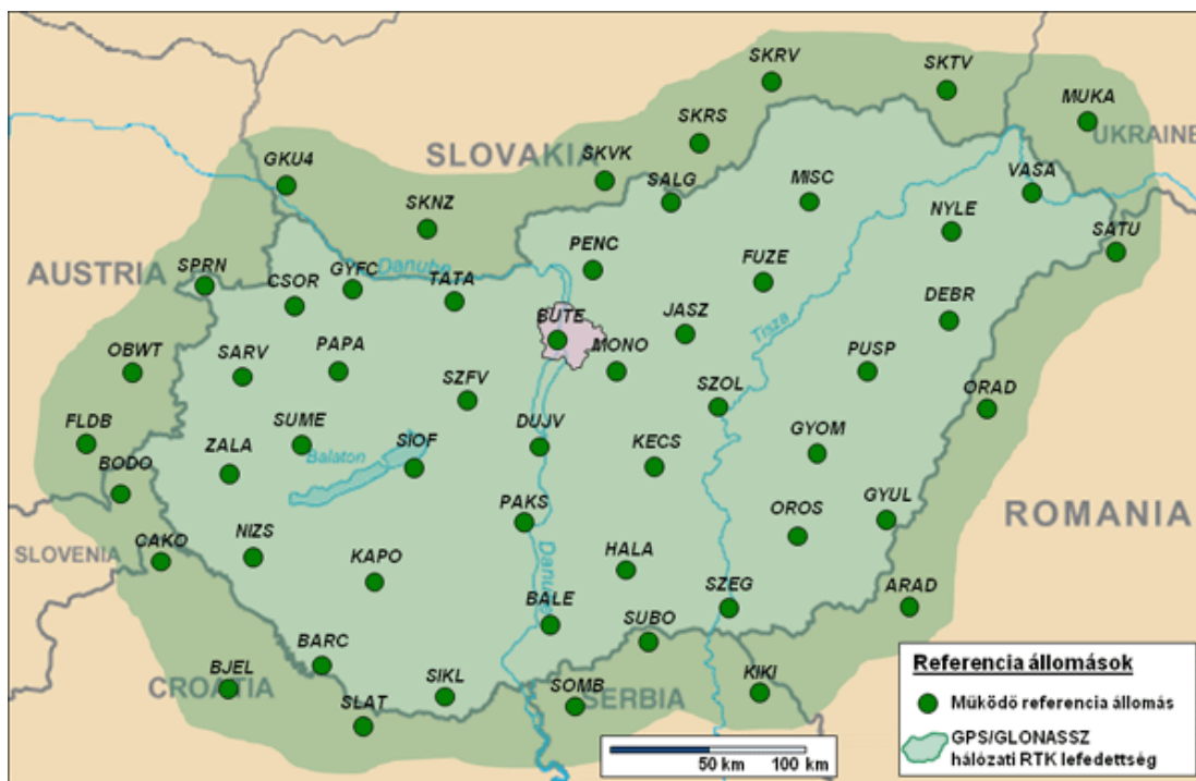
7. ábra. Az aktív GNSS hálózat 2011-ben (forrás: www.gnssnet.hu )
