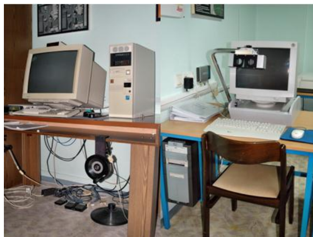
10. ábra. DIAP munkaállomás és DVP munkaállomás tükrös sztereoszkóppal
